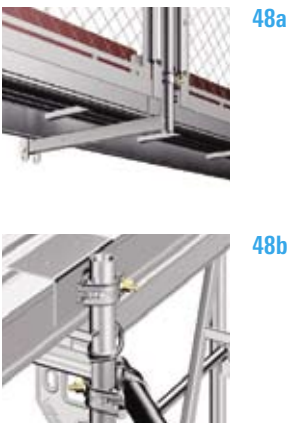
48a Fastsättning av skyddsnettsstolpar. 48b Gångbryggor säkras mot stjälpning och lyftning med specialkopplingar för träplank.
