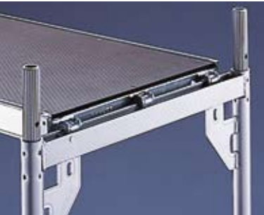
Robustplattformar för ramställning med bredden 0,61 m har tre klor i vardera änden som garanterar säker montering.
