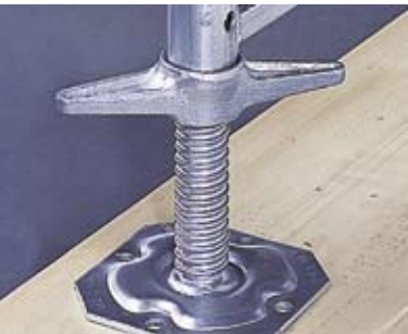
Lättmanövrerade bottenkruvar med självrensande gängor och en vingmutter med överskruvningsskydd ger snabb inriktning i horisontalled.
